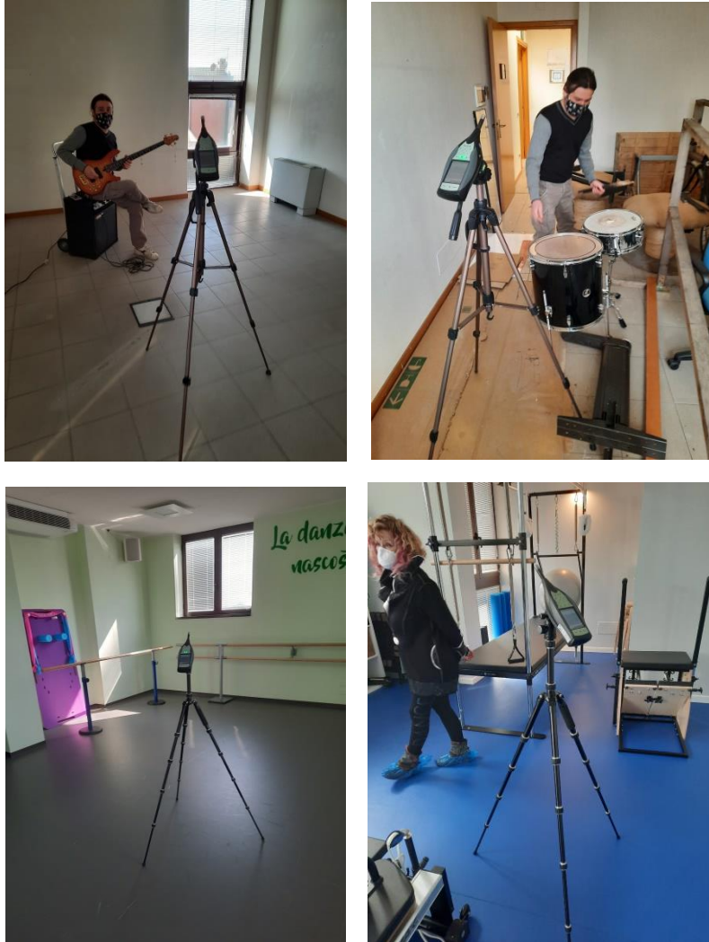
Img. 3.1 - Alcune immagini scattate durante le misure dei livelli sonori emessi dagli strumenti musicali e dall'impianto elettroacustico.
